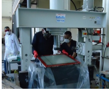
Şekil 1. Kalıbın soğuk pres altına yerleştirilmesi
