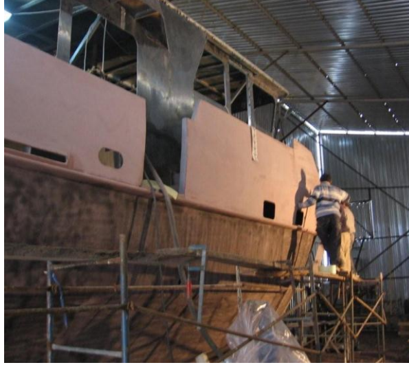
Şekil 2. Yat inşasında kompozit parampet uygulaması
