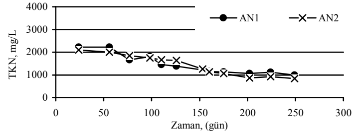
Şekil 10. Anaerobik test hücrelerinde oluşan sızıntı sularında TKN değişimi
